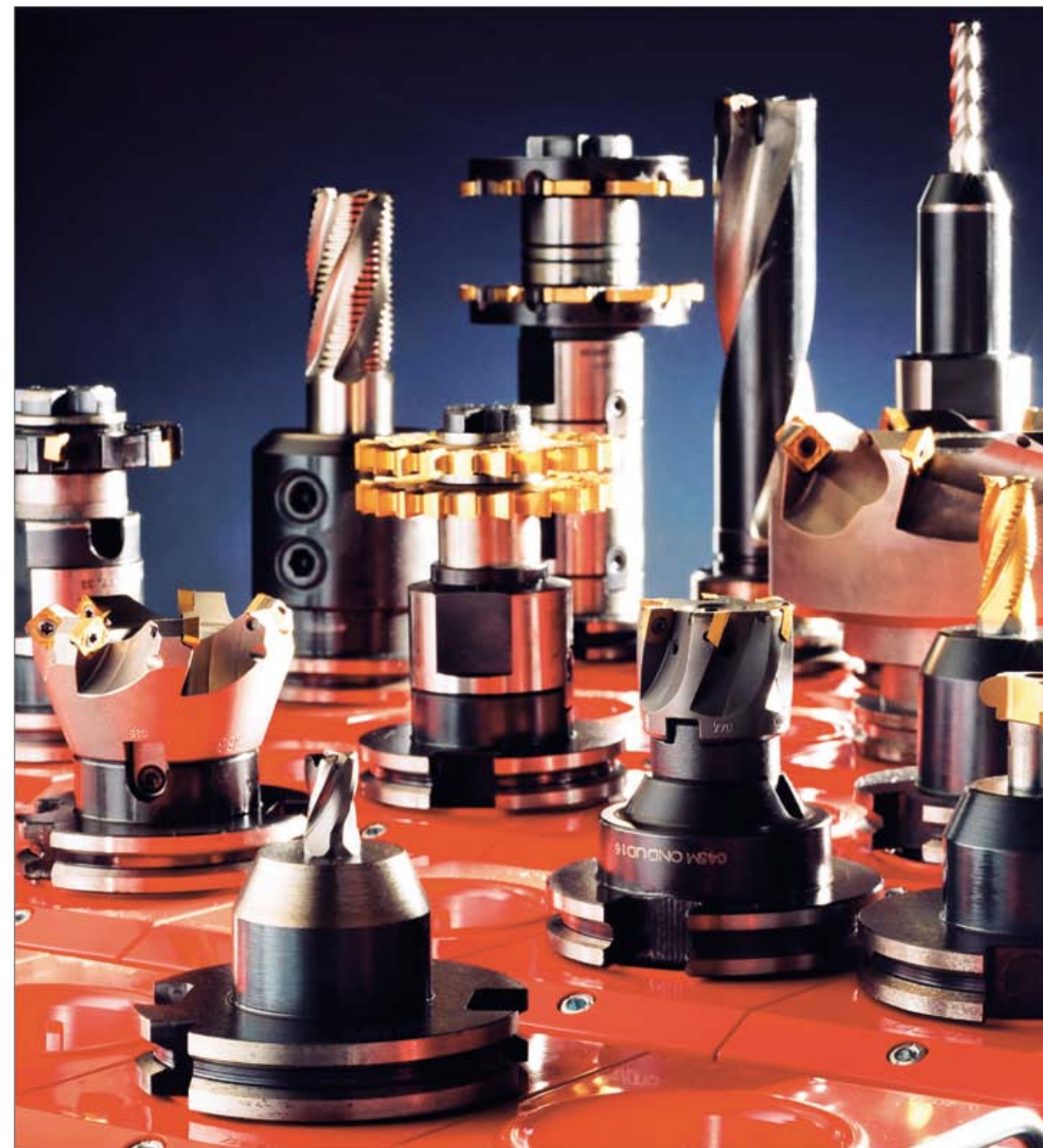
Gros plan sur une des palettes d'outils équipant les centres d'usinage à commandes numériques
